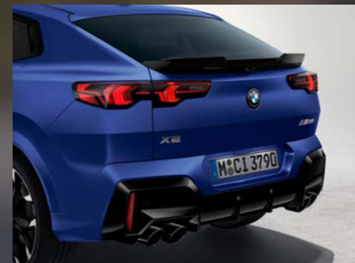
M Heckspoiler Optik trifft Funktion. Der M Heckspoiler erhöht den Anpressdruck an der Hinterachse. Dadurch verbessert er die Fahrstabilität. Besonders bei höheren Geschwindigkeiten. Hochglänzend schwarz lackiert sieht er außerdem besonders sportlich aus.
